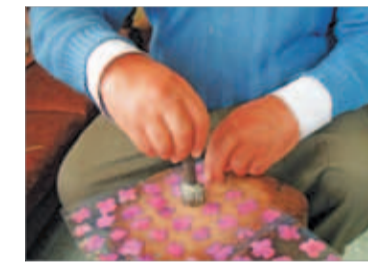
Luego con el troquel se corta lo plastificado. Los troqueles son de varios tamaños de acuerdo con la forma que tengan la flor, el arete o el producto que se vaya a hacer.
